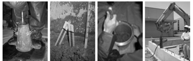
スランプ試験機 カンタブ試験 空気量試験 アンカー引抜試験
