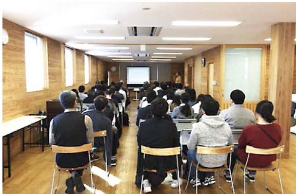
写真2 天井を不燃化・壁を木質化した空間は火災初期に容易に燃え広がらない（H12建設省告示第1439号）
